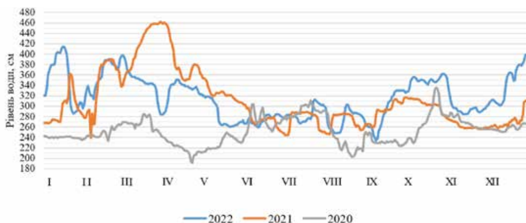
Рис. 2. Графік щоденних рівнів води р. Стир (гідропост Луцьк) за 2020–2022 рр.* *Побудовано за даними Волинського ЦГМ (12.07.2024)
