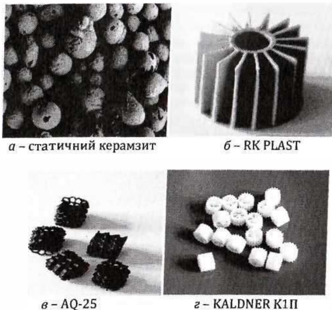
Рис. 6 (а, б, в, г). Зовнішній вигляд наповнювачів біофільтра, які використані в досліді
