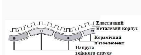
Рис 2. П'єзодвигун на основі рухомої хвилі
