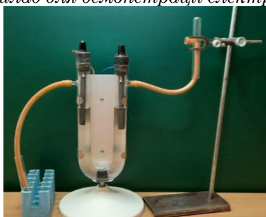
Рис. 9. Використання U-подібної трубки для електродолізу води
