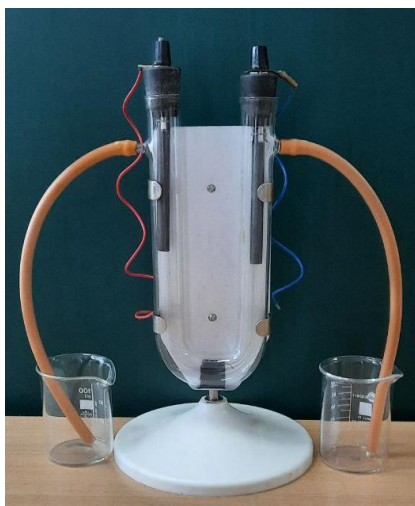
Рис. 6. U-подібна трубка для електролізу розчинів солей
