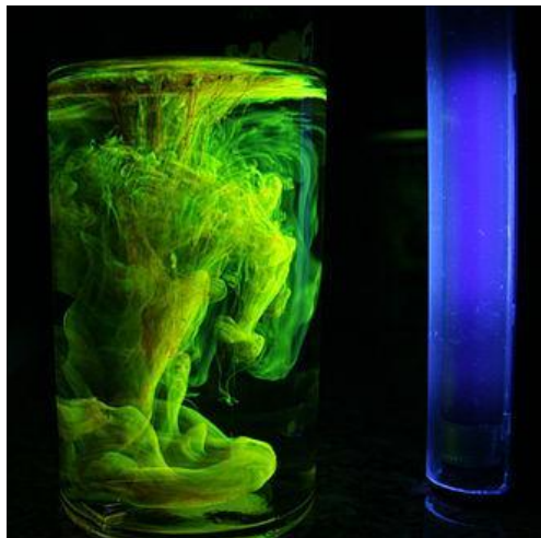
Рис.21. Світіння лужного розчину флуоресцеїну під дією ультрафіолетового випромінювання
