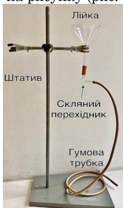
Рис. 22. Установка для демонстрації горіння пилу крохмалю
