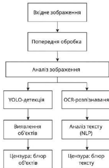
Рис 1. Схема роботи машинного зору
