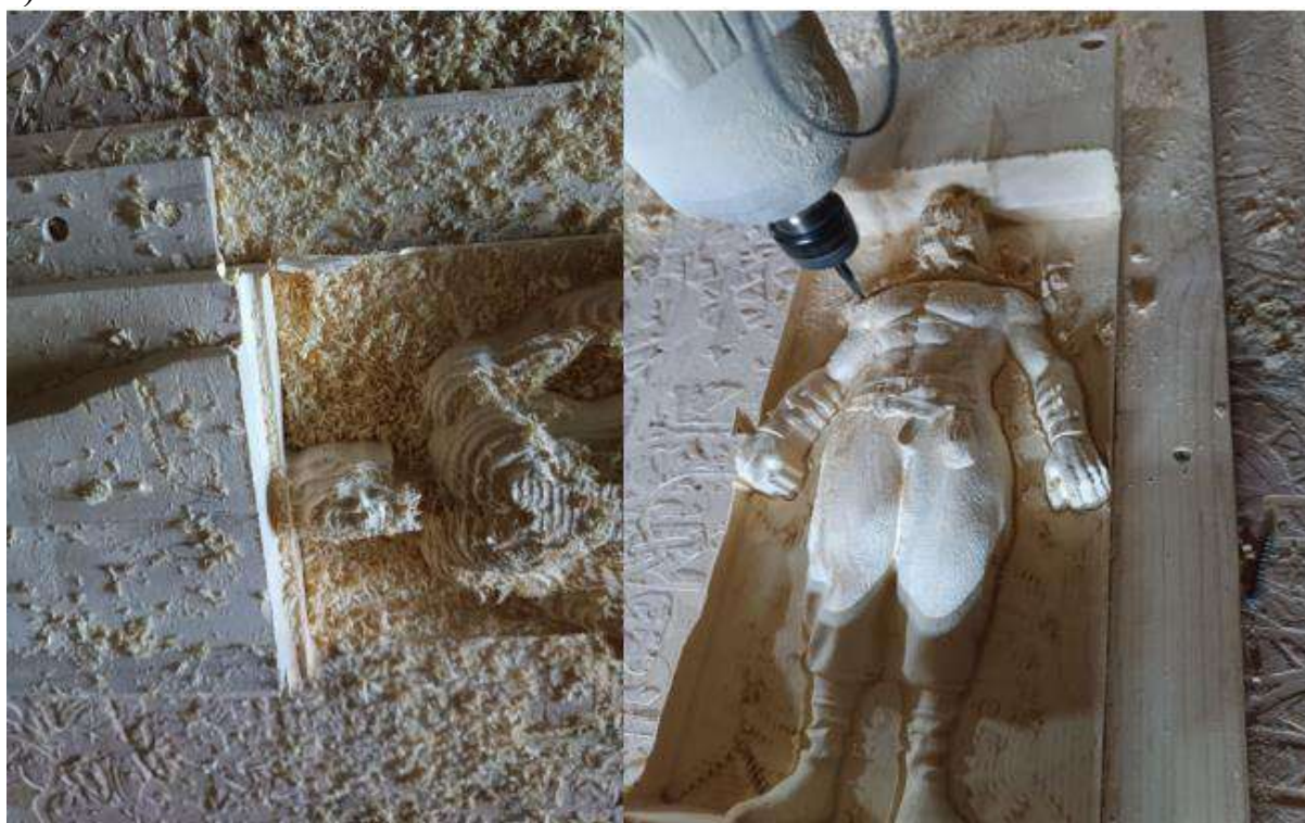
Рис. 2. Демонстрація чорнової та фінішної обробки фрезою
