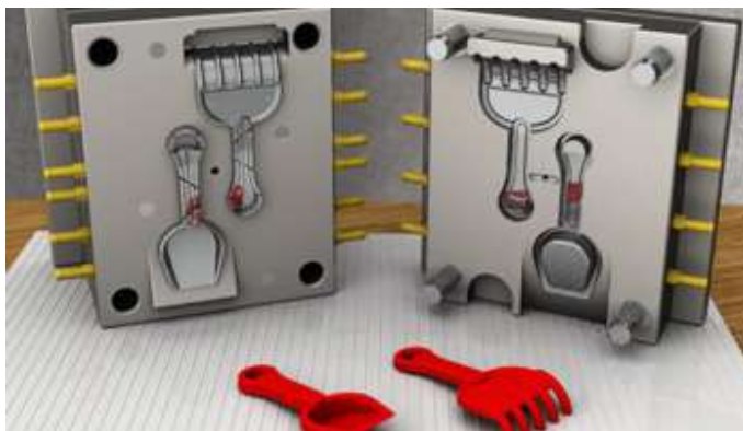
Рис. 117. Фото прес-форми для виготовлення пластикових іграшок (фото з сайту продажу прес-форм в Україні)
