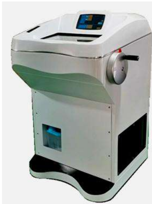
Рис. 7. Мікротом-криостат «МК100» для виготовлення заморожувальних зрізів.
