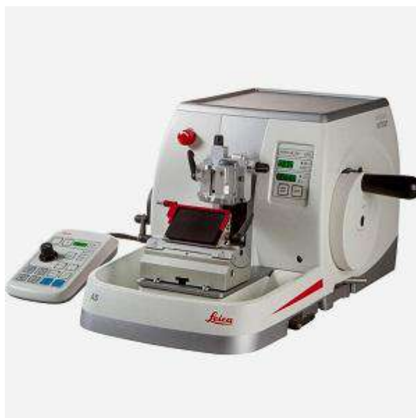
Рис. 5. Автоматичний ротаційний мікротом (призначений для повністю автоматичного виготовлення зрізів) «HistoCore AUTOCUT».
