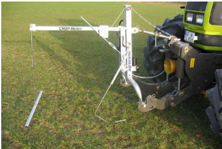
Рис. 118. Інноваційний датчик біомаси GROF-METER AGROCOM
