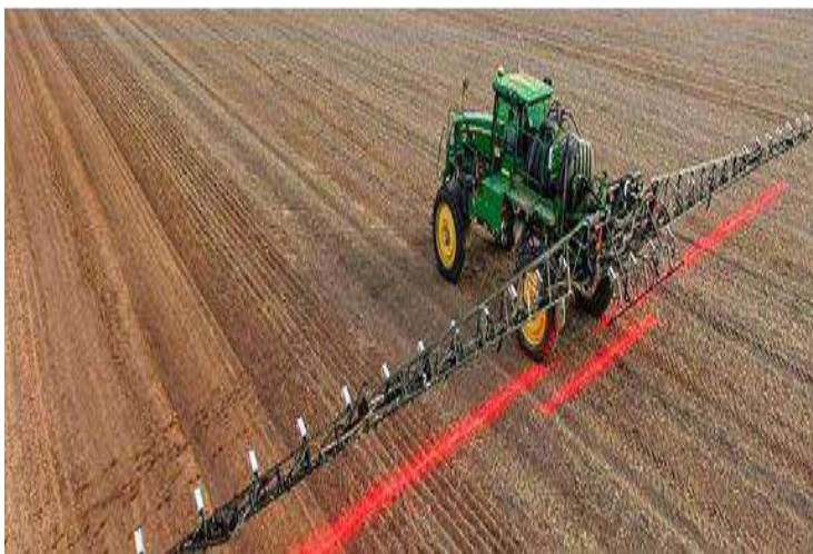
Рис. 109. Система WEED-IT виконує внесення ЗЗР із виявленням бур'янів за допомогою інфрачервоних датчиків (джерело – SmartSensing)
