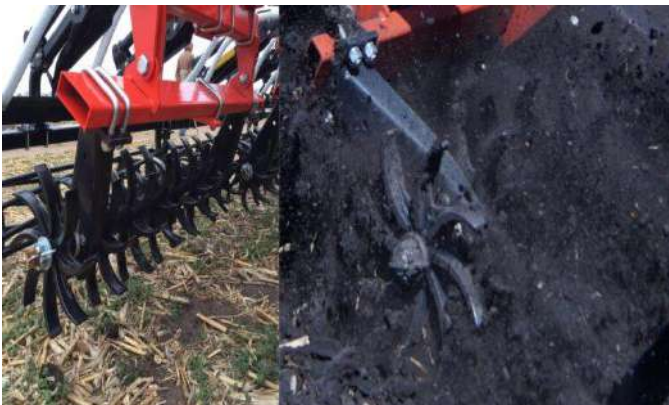
Рис. 14. Подрібнення грудок та притискання пожнивних решток до ґрунту чавунними зірочками
