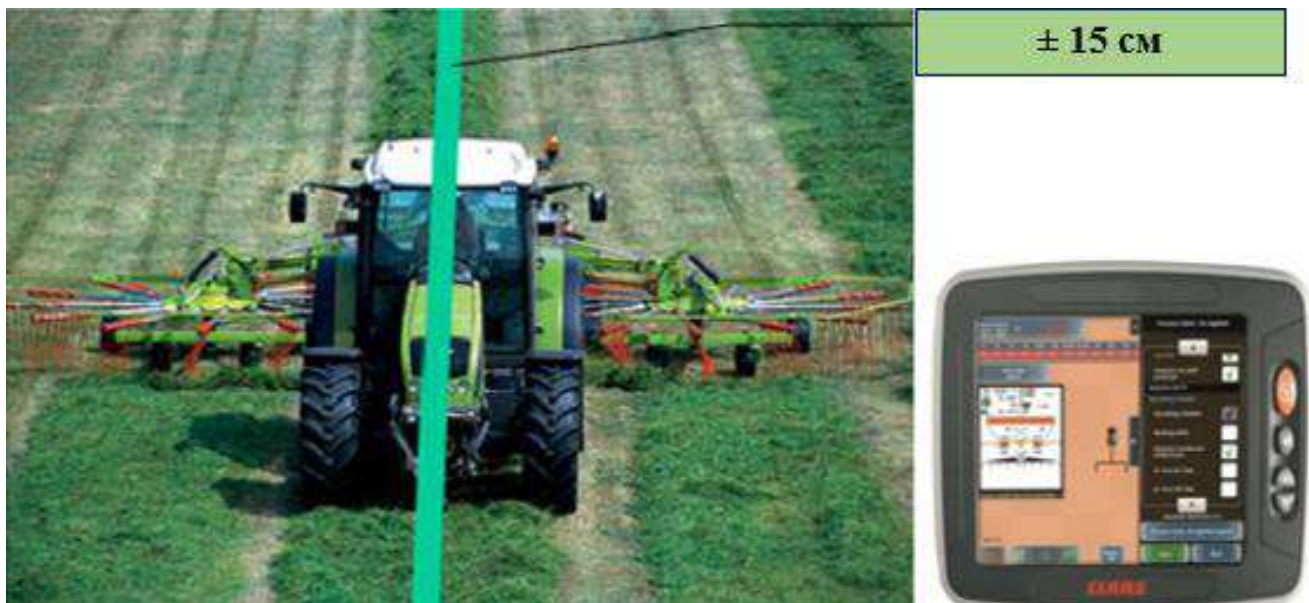
Рис. 51. Claas copilot S 7 і RTK мобільна станція при роботі з сигналом EGNOS або EDIF
