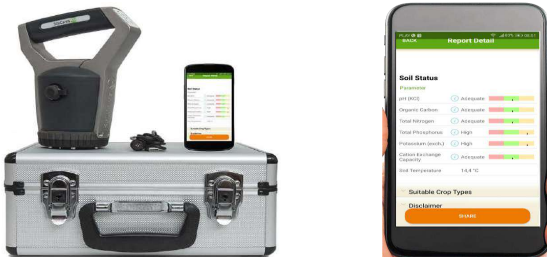
Рис. 32. Soil Scanner для визначення вмісту гумусу та основних елементів живлення в ґрунті
