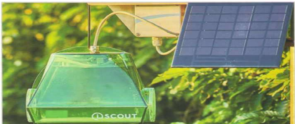
Рис. 96. Феромонна пастка із системою оптичних камер для розпізнавання цільових комах, автономного живлення та передачі даних на комп'ютер
