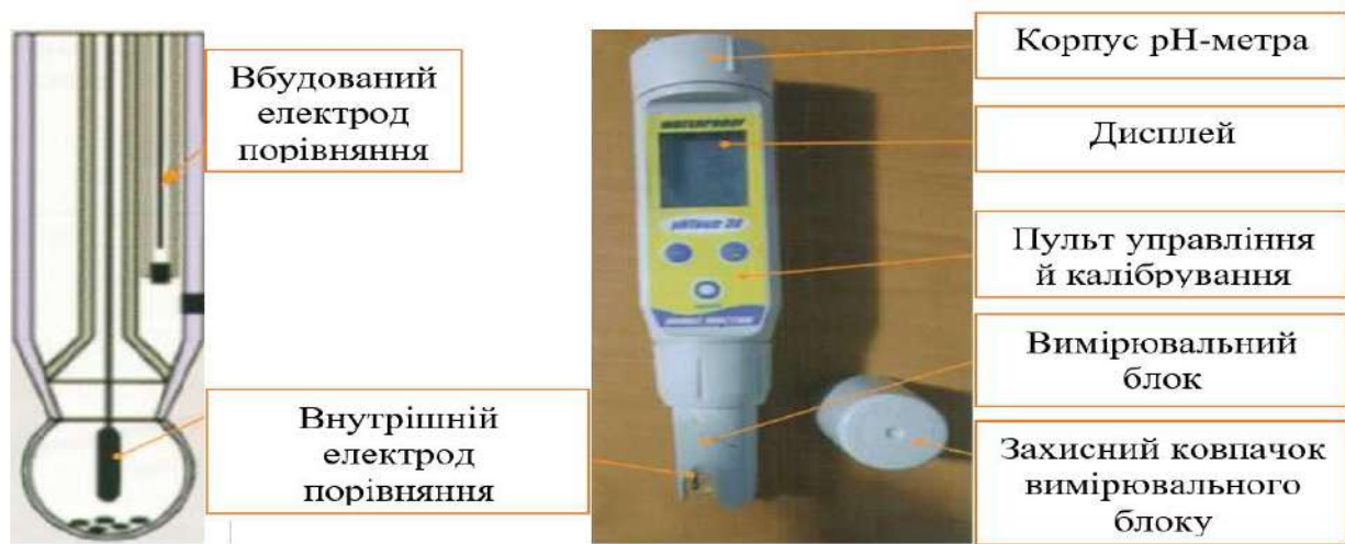
Рис. 34. Польовий рН-метр
